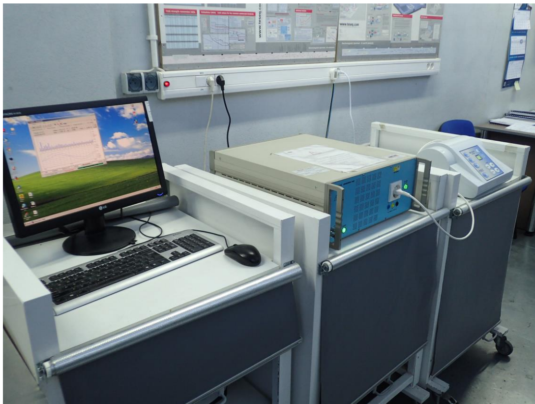
Fot. 5. Pomiar harmonicznych prądu
