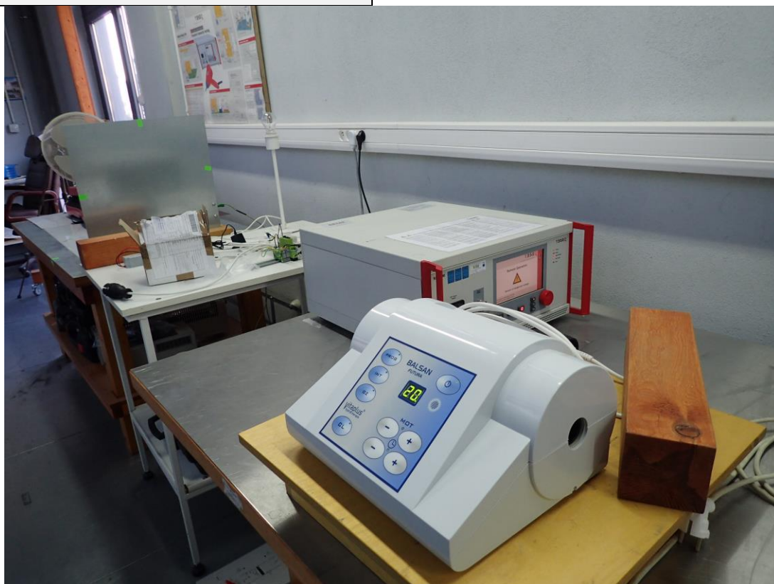
Fot. 8. Pomiar odporności na udary (SURGE)
