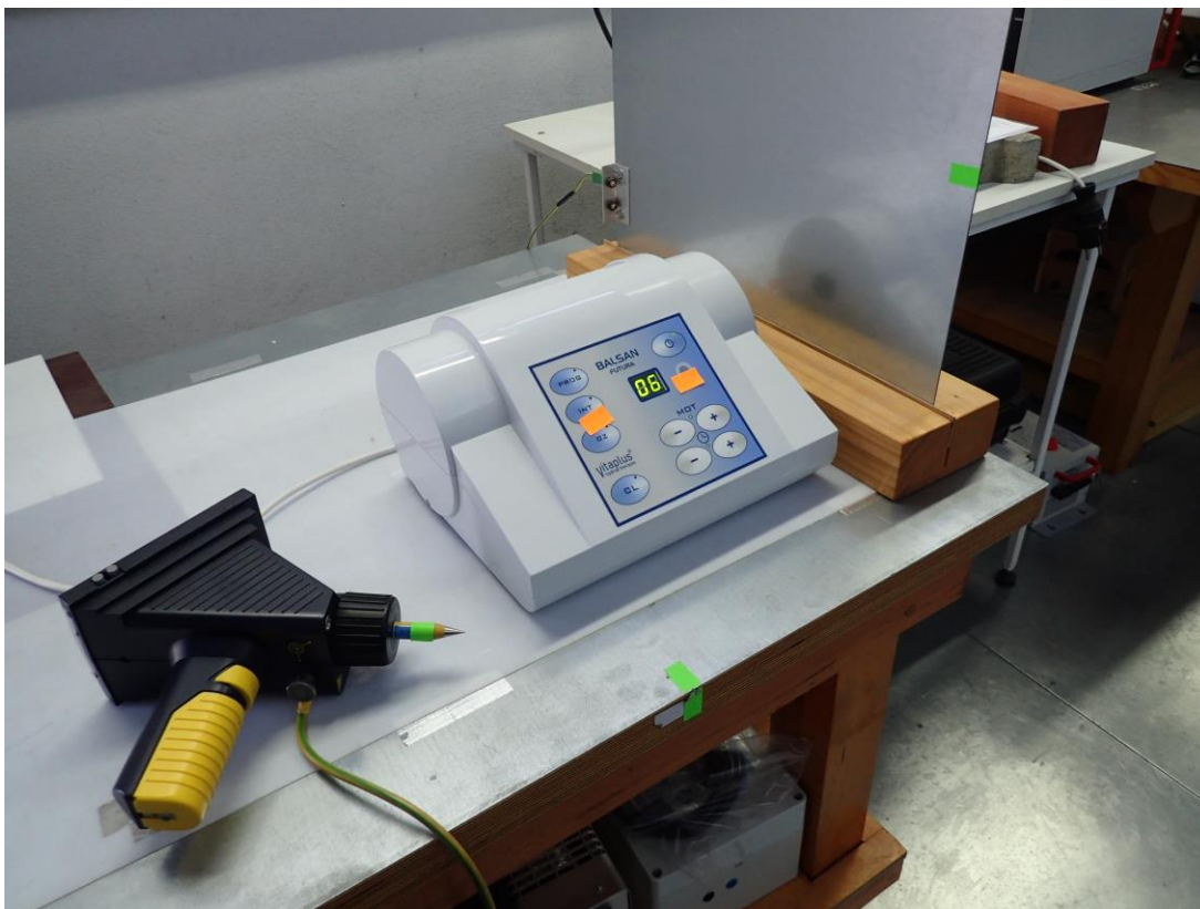
Fot. 6. Pomiar odporności na wyładowania elektrostatyczne (ESD)
