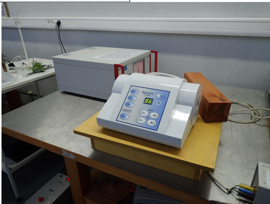
Fot. 7. Pomiar odporności na szybkie stany przejściowe (BURST)
