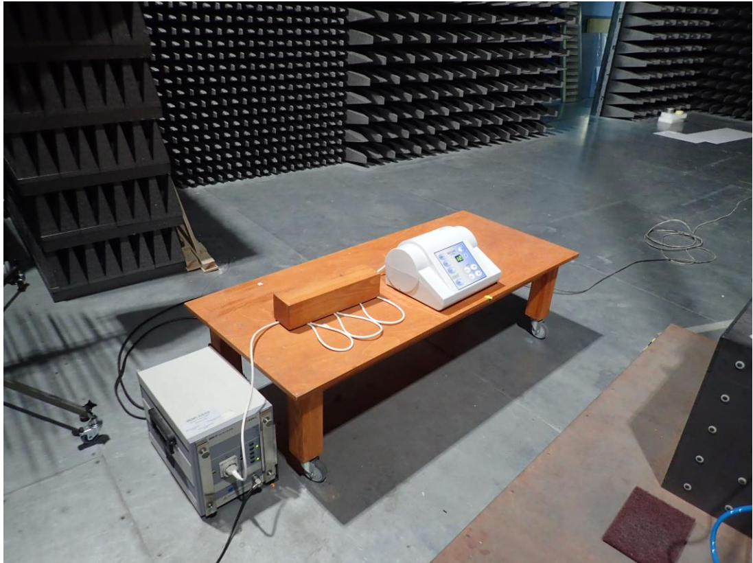
Fot. 3. Pomiar zaburzeń przewodzonych
