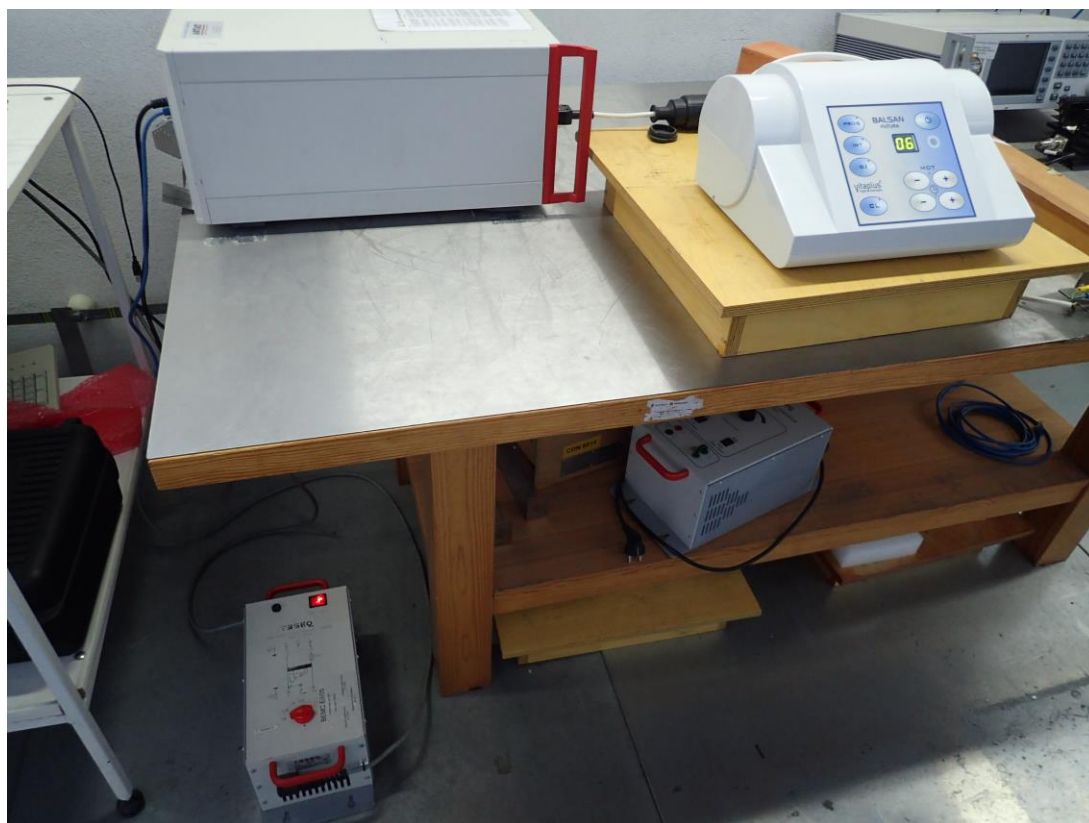
Fot. 10. Pomiar odporności na zapady i zaniki napięcia zasilającego
